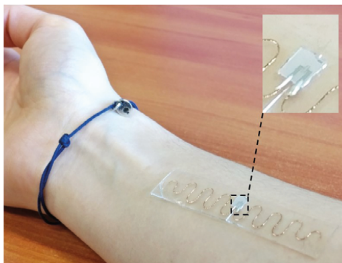
Représentation d'un capteur sans fil et ultrasouple placé sur la peau. © S. Hage-Ali, projet SAWGOOD.
