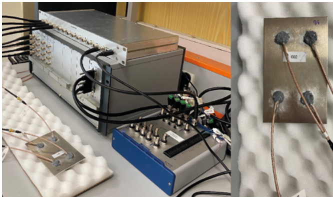
À gauche, équipement développé pour l'interrogation active et passif de pièces aéronautiques métalliques par ondes ultrasonores. À droite, un coupon de test équipé d'éléments actifs piézoélectriques. © V. Lozada, projet COQTEL.
