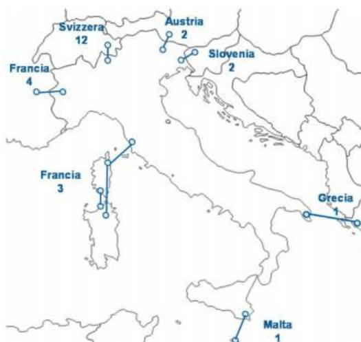
In adempimento agli obblighi di concessione di Terna sono oggi in fase di realizzazione o di progettazione preliminare: il collegamento HDVC Piossasco - Grand'Île (Italia - Francia), il collegamento 132 kV Prati di Vize/Brennero (Italia - Austria), il collegamento Sardegna - Corsica - Italia continentale SACOI3 (Italia - Francia), il collegamento Italia - Tunisia (progetto ELMED) e il collegamento HVDC Villanova - Tivat (Italia - Montenegro, in completamento).
