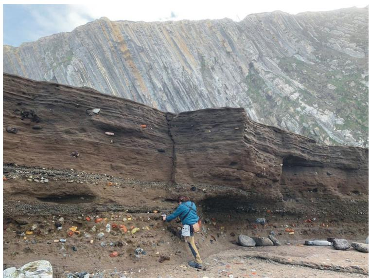
Medida de la susceptibilidad magnética del depósito antropogénico de Tunelboca (sensor MS2K, perfil estratigráfico).
