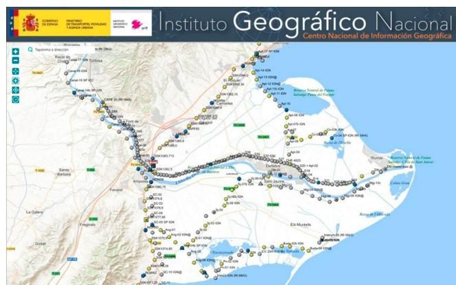
Nuevas líneas de nivelación de alta precisión en el delta del Ebro.
